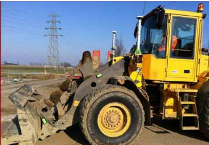
Radlader mit installierten Sensoren und GNSS-Empfängern
